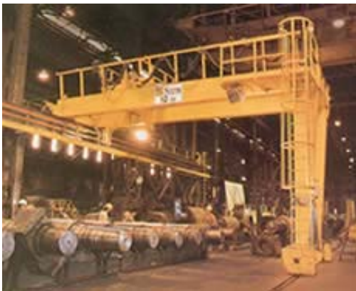
Planta de laminación: Grúa pórtico de servicio pesado
