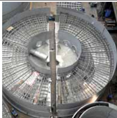
El equipo terminado utilizó para su construcción 480 ton. de acero inoxidable.
