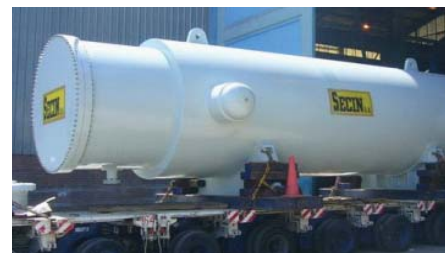
Intercambiador de Calor E 504
