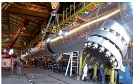
Reactor de Tratamiento de Parafinas
